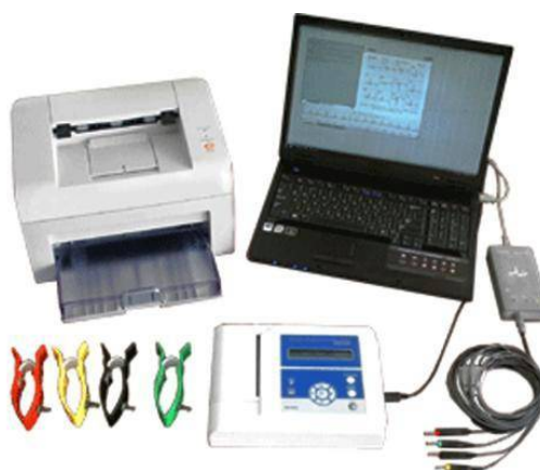
Рис. 2.2. Аппаратная часть комплекса анализа variability сердечного ритма
